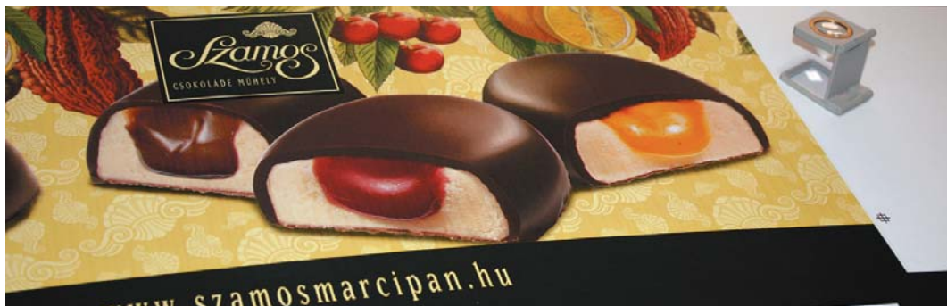
DigiCorr-os nyomóformával nyomtatott, mázolt fedőrétegű, EB hullámú lemez – a hullámbordák hatása a kritikusabb homogén felületeken is jelentősen mérséklődött
