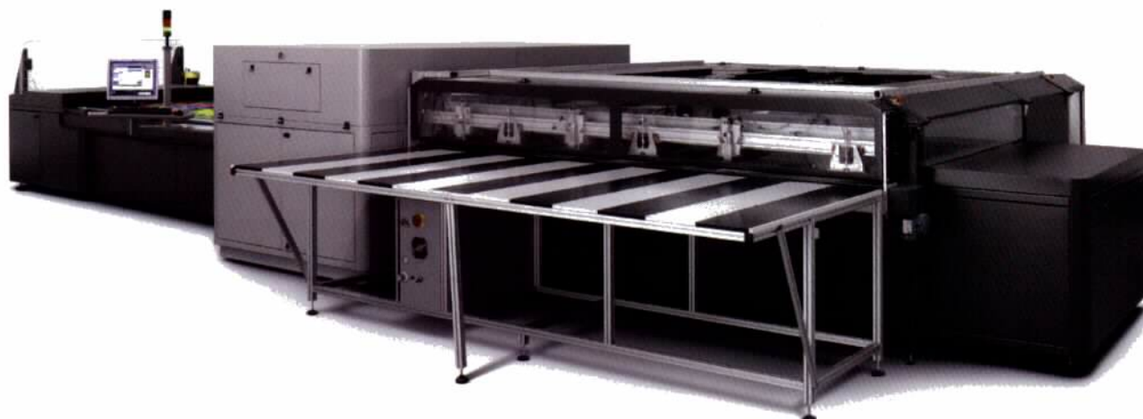
1. ábra: HP Scitex FB7600 síkgyas, digitális ipari UV-nyomógép
